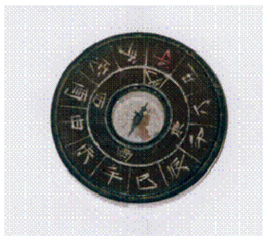
写真2 小型船舶用方位磁石(日本)
