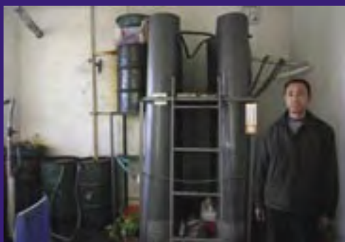
炭鉱排水の浄化実験。飲用以外には使えるレベルまでできたが、現在、事情で中断中。
