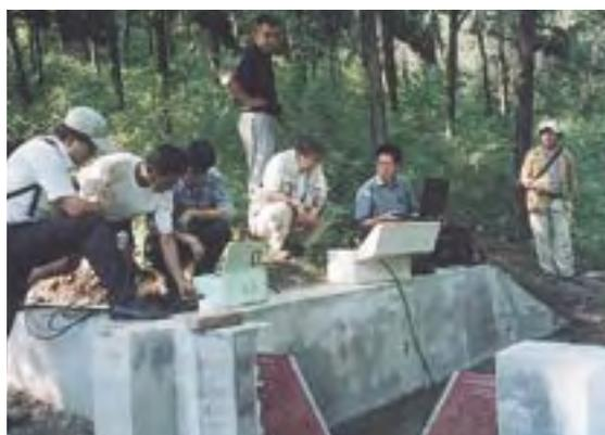
【写真39】 幼林斜面実験流量観測点ではVノッチで流量を自動観測している
