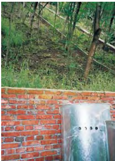
【写真113】 植生による土砂防止効果を測定するための実験斜面
