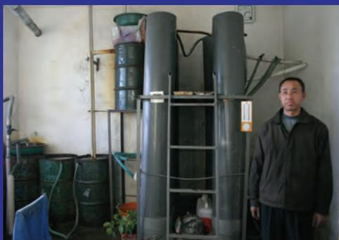
炭鉱排水の浄化実験。飲用以外には使えるレベルまできたが、現在、事情で中断中。
