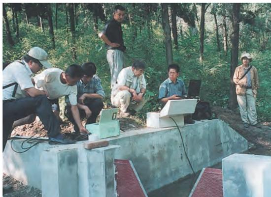
【照片39】在幼林斜面实验流量观测点，用V形槽口自动观测流量
