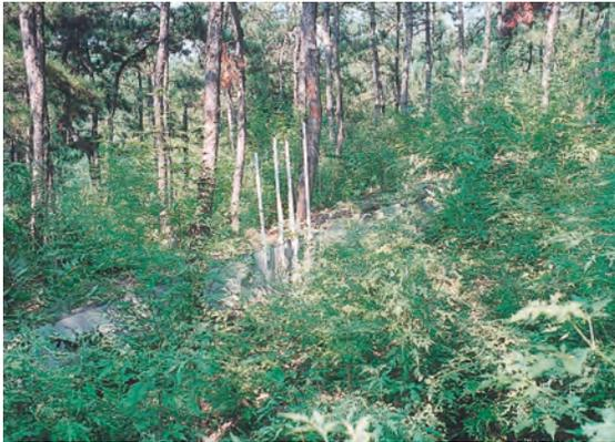
【照片40】幼林地的地中水流观测斜面，用灌水测量计观测土壤水分
