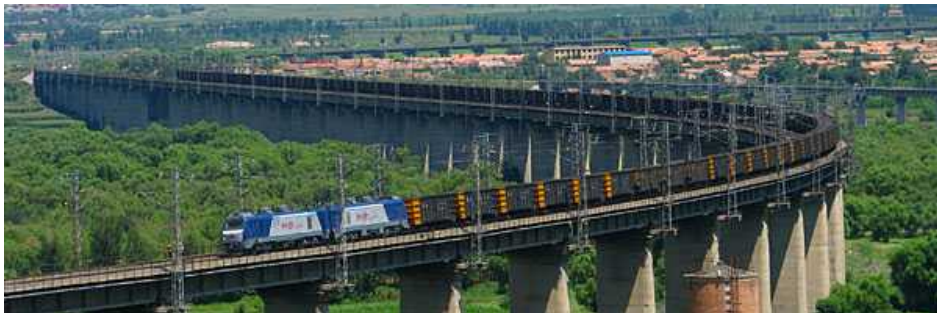
写真1:「大秦線」を駆ける世界最長の貨物列車（編成全長2.6km、最大編成216両） 出典：Borgen 中国鉄道倶楽部「大秦線」 http://railway.org.cn/oda/oda02.html
